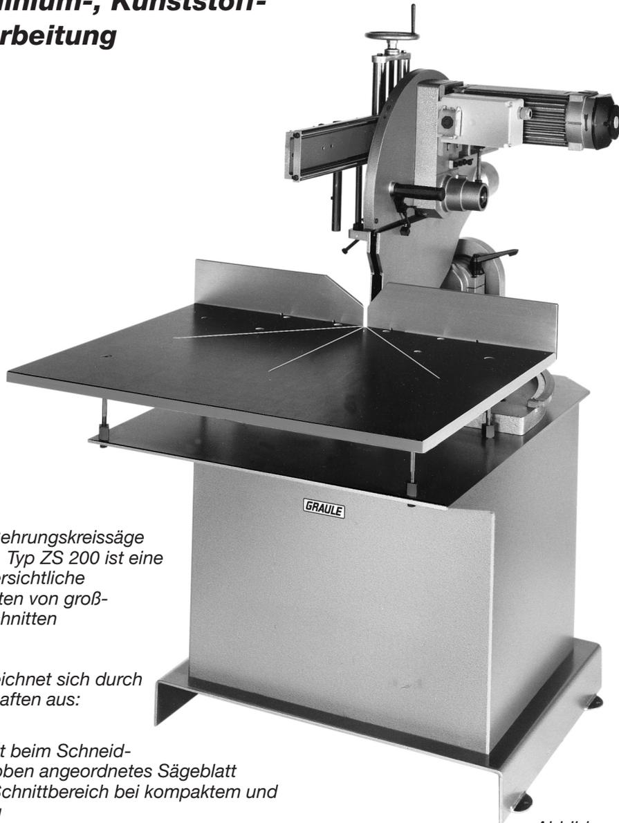
Die Abläng- und Gehrungskreissäge Typ ZS 200 N bzw. Typ ZS 200 ist eine kompakte und übersichtliche Säge zum Bearbeiten von großformatigen Querschnitten
